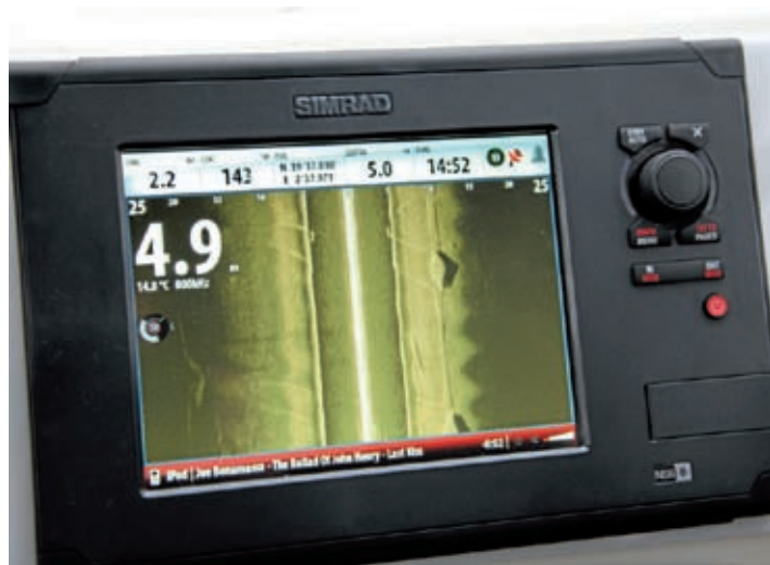
Patentet StructureScan er teknologi som lager bilde av havbunnen under båten. Systemet er imidlertid ikke ment for å finne fisk.
